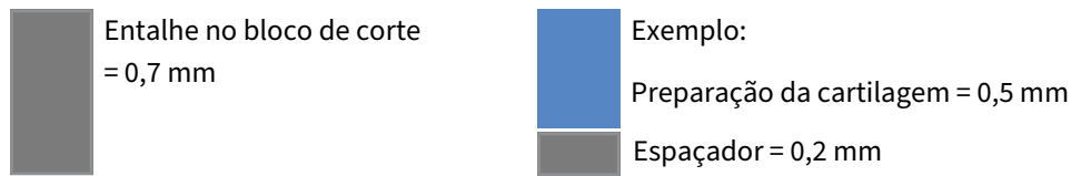
Fig. 3: Espessura da preparação da cartilagem = 0,7 mm menos a espessura dos espaçadores
